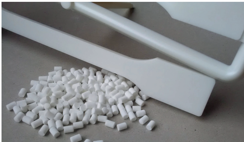
Van SLS-geprint PA12-granulaat werden de teststaafjes gemaakt
